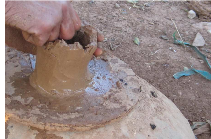
الصورة 4: تسوية النتوءات الزائدة للأنية o\% \text{Z}o \wedge \wedge o\% \text{O} | o\% \text{Z}o \text{H}+
