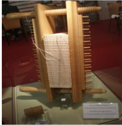
(الصورة 19): آلة خياطة المخطوطات (المرمة)، وبجانبتها شمع لتسهيل عملية الخياطة المصدر: رواق وزارة الثقافة، المعرض الدولي للنشر والكتاب -الدار البيضاء- 2009 (عدسة الكاتب)
